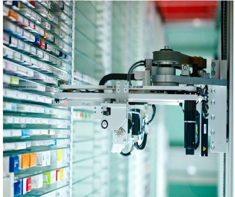
Аптечный робот — робот, который устанавливается в аптеке для оптимизации хранения, поиска и выдачи медикаментов непосредственно к рабочему месту фармацевта
