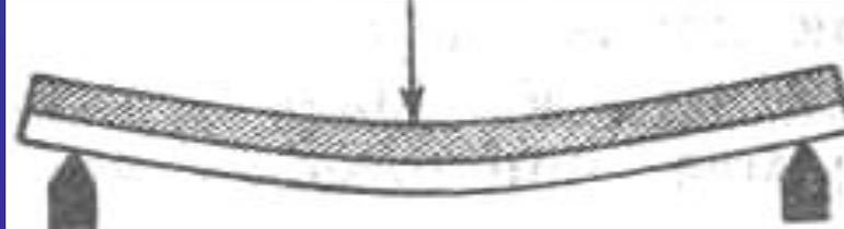
Деформацию изгиба испытывает, например, нагруженная балка.
