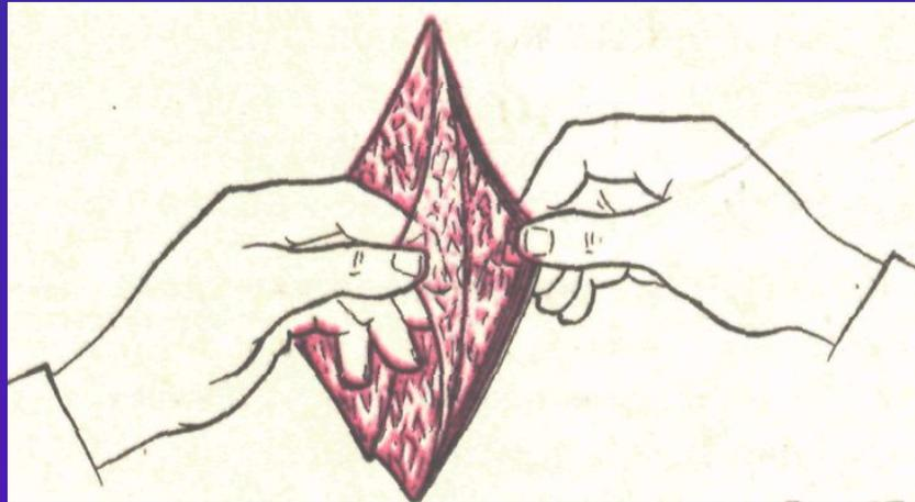
Например, кусок слюды легко расслаивается в одном из направлений на тонкие пластинки, но разорвать его в направлении, перпендикулярном пластинкам, гораздо труднее.
