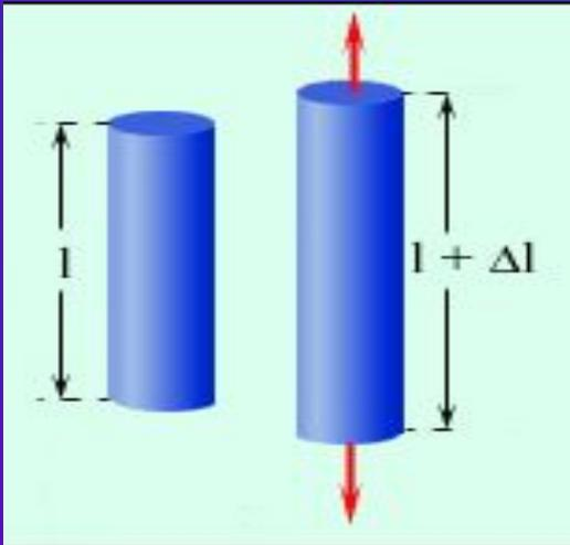
Деформацию растяжения испытывают тросы, канаты, цепи в подъемных устройствах, стяжки между вагонами и т. д.
