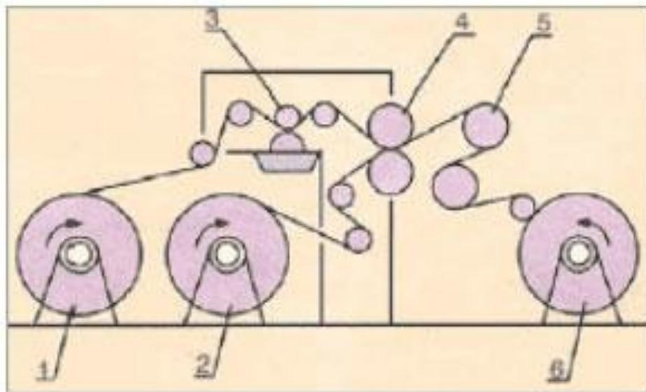
1, 2 - места раскручивания соединяемых материалов, 3 — нанесение расплавленной массы, 4 — ламинирующие ролики, 5 — охлаждающий цилиндр, 6 — место скручивания ламината.
