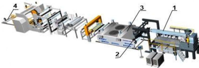
*1 – экструдер, 2 – плоскощелевая головка, 3 – система охлаждения пленки, 4 – намотчик.*
