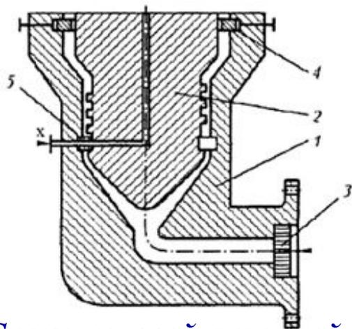
*Схема угловой рукавной головки с центральной подачей расплава.*
