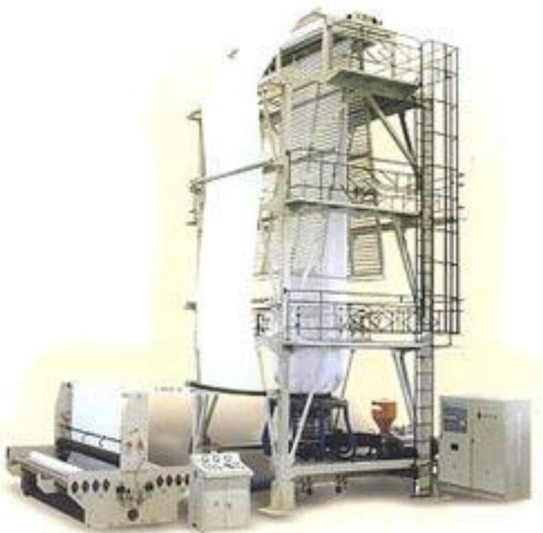
Существуют три основные схемы производства рукавной пленки: приемкой раздуваемого рукава вверх (наиболее распространена), вниз и в горизонтальном направлении.
