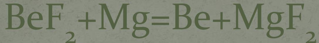
В настоящее время бериллий получают, восстанавливая его фторид магнием, либо электролизом расплава смеси хлоридов бериллия и натрия.
