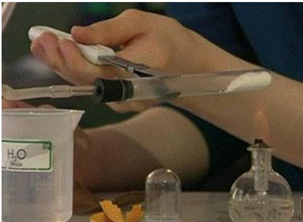
Аммиак можно получить нагреванием смеси соли - хлорида аммония и гидроксида кальция. При нагревании смеси происходит реакция образования соли, аммиака и воды.
