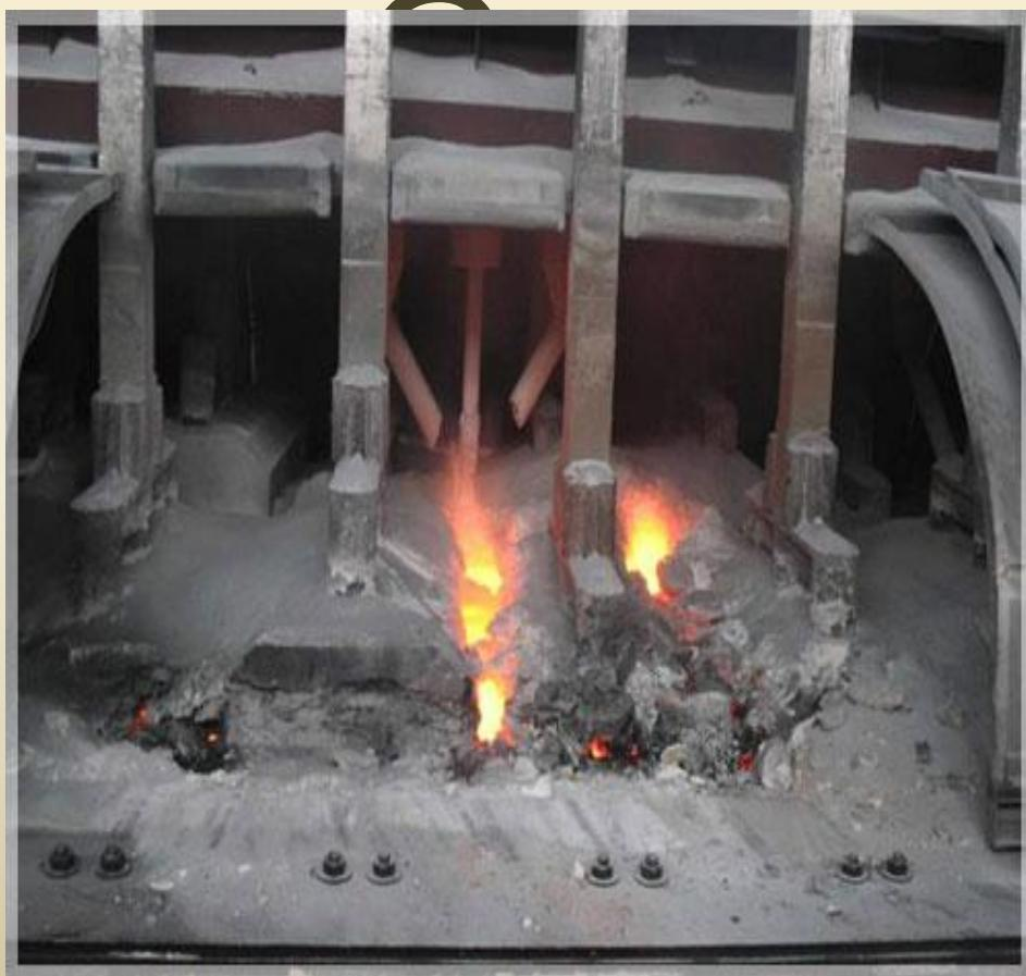
*Он заключается в растворении оксида алюминия в расплаве криолита с помощью электролиза.*
