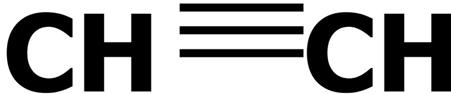
Атомы углерода в молекуле ацетилена образуют тройную связь, находятся в состоянии **SP** гибридизации
