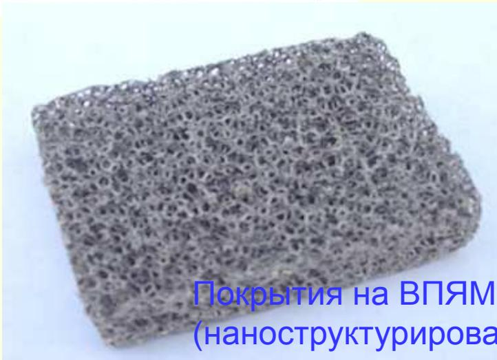
Покрyтия на ВПЯМ – катализаторы (наноструктурирование)
