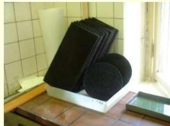
Нанесенные на пеноникель сложнооксидные катализаторы.
