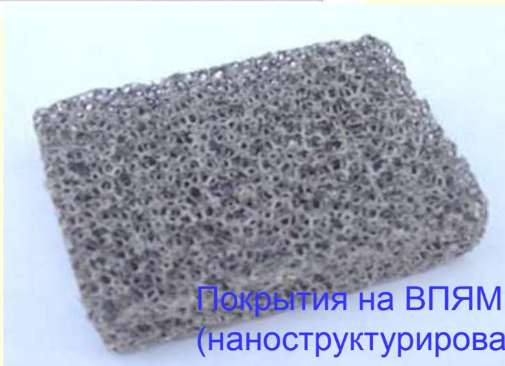
Покрyтия на ВПЯМ – катализаторы (наноструктурирование)
