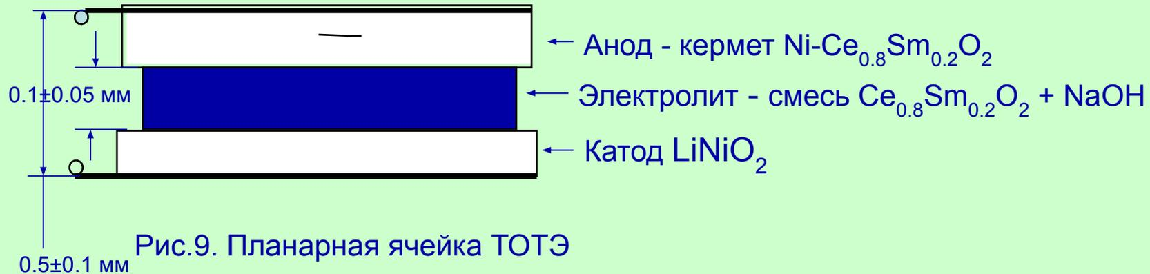
Рис.9. Планарная ячейка ТОТЭ
