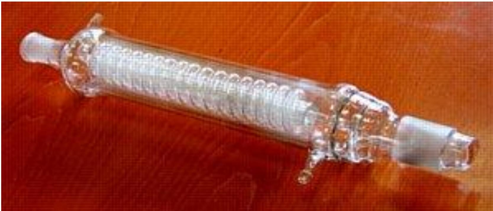
обратный холодильник используется для конденсирования паров и возврата конденсата в реакционный сосуд
