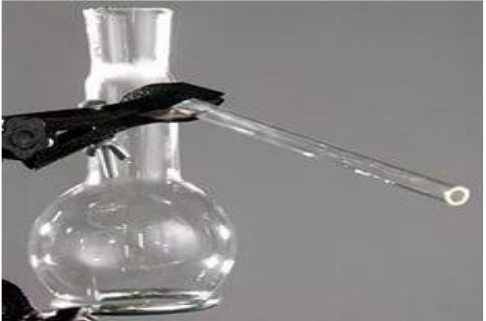
колба Вюрца используется как - составная часть прибора для перегонки
