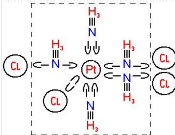
В общем случае: комплексными соединениями называют химические соединения, образованные сочетанием отдельных компонентов, содержащие в своем составе сложные ионы или молекулы, способные к самостоятельному существованию как в кристалле, так и в растворе.
