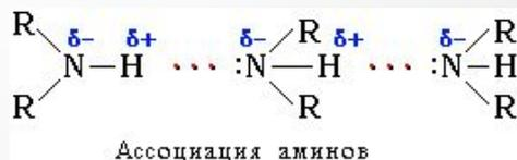
Это объясняет относительно высокую температуру кипения аминов по сравнению с неполярными соединениями со сходной молекулярной массой
