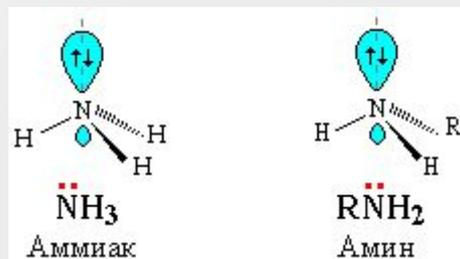
Поэтому амины и аммиак обладают свойствами оснований (акцепторов протона) и нуклеофильных реагентов (частиц, способных предоставить пару электронов для связи с атомом углерода).
