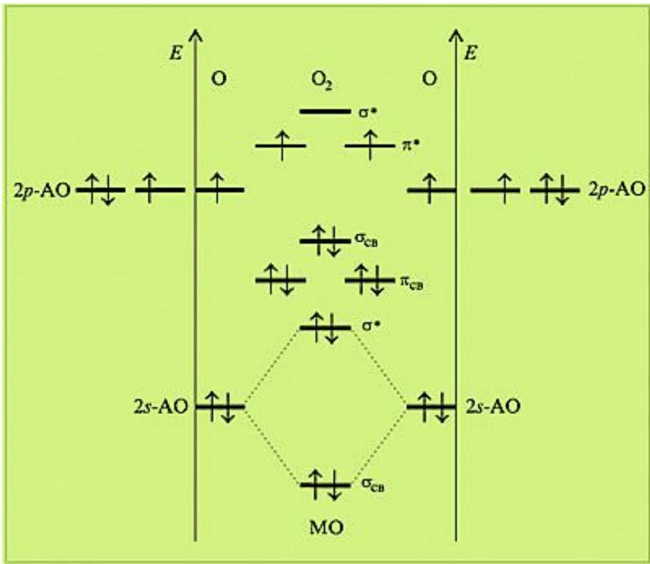
Энергетическая диаграмма, иллюстрирующая с помощью метода МО ЛКАО парамагнитные свойства молекулы  $O_2$
