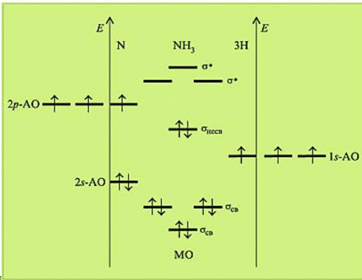
Поскольку три атома водорода имеют только три  $1s$ -орбитали, то суммарное число образованных молекулярных орбиталей будет равно шести (три связывающих и три разрыхляющих). Два электрона атома азота окажутся на несвязывающей молекулярной орбитали (неподеленная электронная пара).
