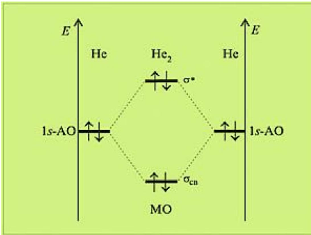
Энергетическая диаграмма, иллюстрирующая с помощью метода МО ЛКАО невозможность образования химической связи между атомами He
