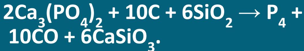
Предварительно измельченная и обогащенная фосфорсодержащая руда смешивается в заданных соотношениях с кремнеземом и коксом и загружается в электропечь. Кремнезем необходим для снижения температуры реакции, а также увеличения ее скорости за счет связывания выделяющейся в процессе восстановления окиси кальция в силикат кальция, который
