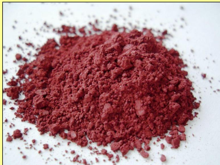
На свету и при нагревании до  $300^{\circ}\text{C}$  без доступа воздуха белый фосфор превращается в красный фосфор.
