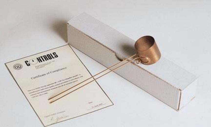
Для определения равномерности изменения объема цемента и гашеной извести.
