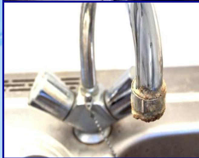
При питании паровых котлов жесткой водой образуется накипь. Накипь затрудняет нагревание воды, вызывает увеличение расхода топлива, ускоряет изнашивание стенок котла.
