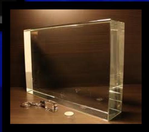
**Физико-химические** - твёрдое тело, структурно — аморфно, изотропно; все виды стёкол при формировании преобразуются в агрегатном состоянии — от чрезвычайной вязкости жидкого до так называемого стеклообразного
