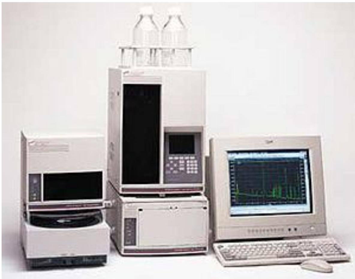
**Один из наиболее распространенных и современных жидкостных хроматографов фирмы Shimadzu**
