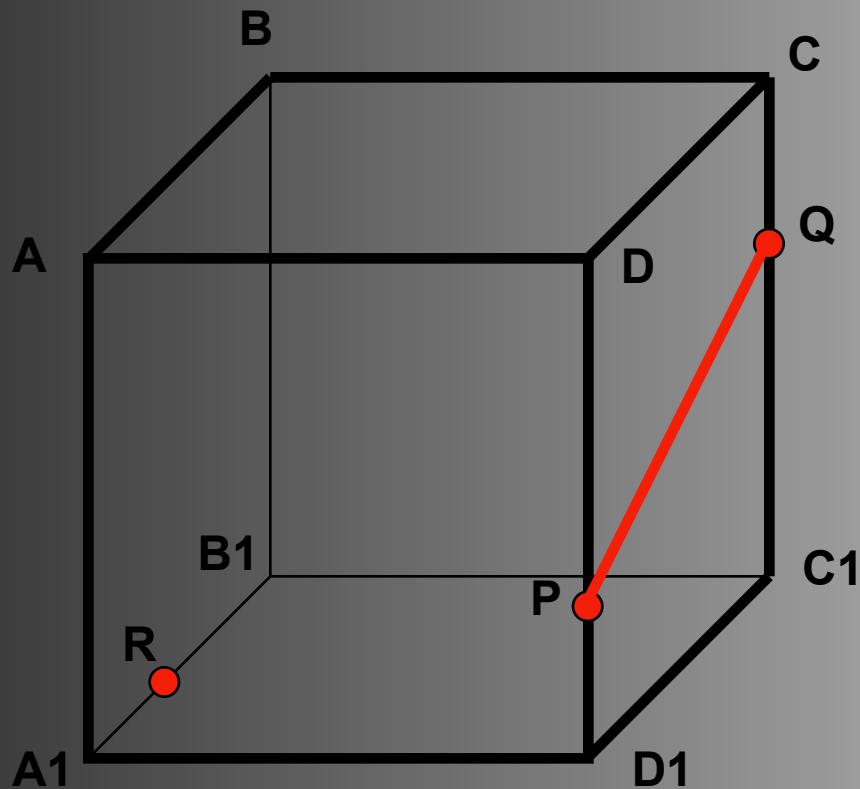
Точки Р и Q заданы, как принадлежащие плоскости сечения. В то же время эти точки принадлежат плоскости грани CD D<sub>1</sub> C<sub>1</sub>, следовательно линия PQ является линией пересечения этих плоскостей
