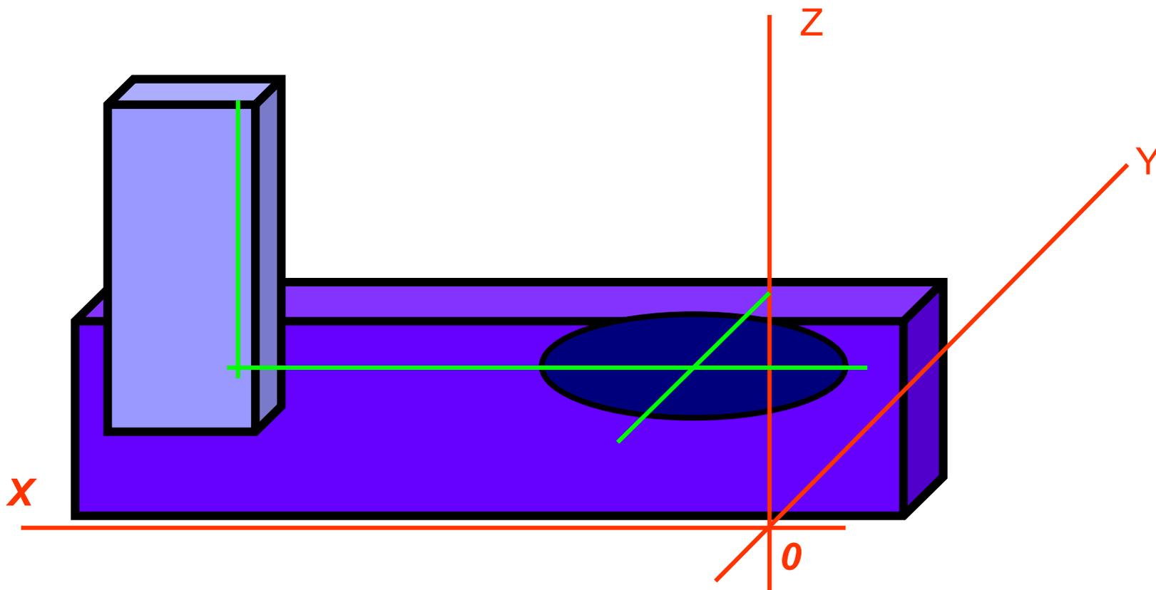
**3. Нарращивание изображений частей предмета (в начале призматической, а затем цилиндрической формы)**
