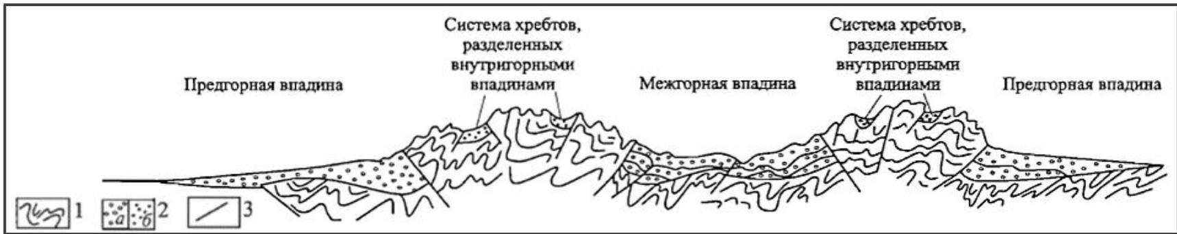
Принципиальный геолого-геоморфологический профиль через горное сооружение коллизионного типа
