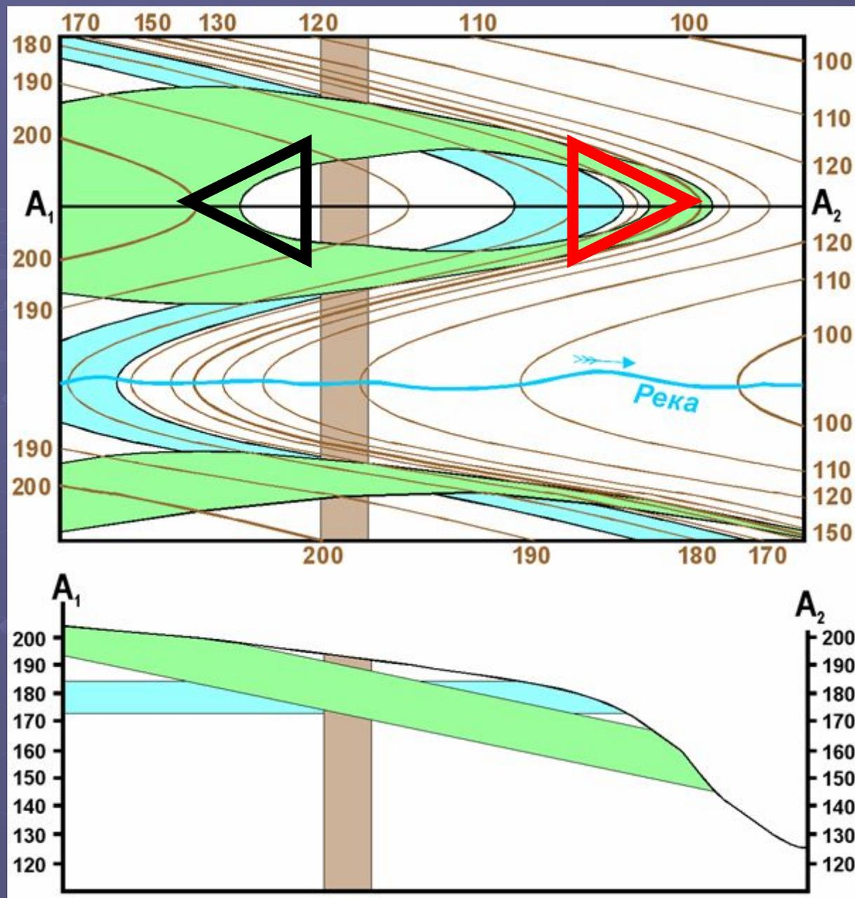
2. Выход полого наклоненного пласта на разрезе долины (на западе положе склона, на востоке – круче склона)
