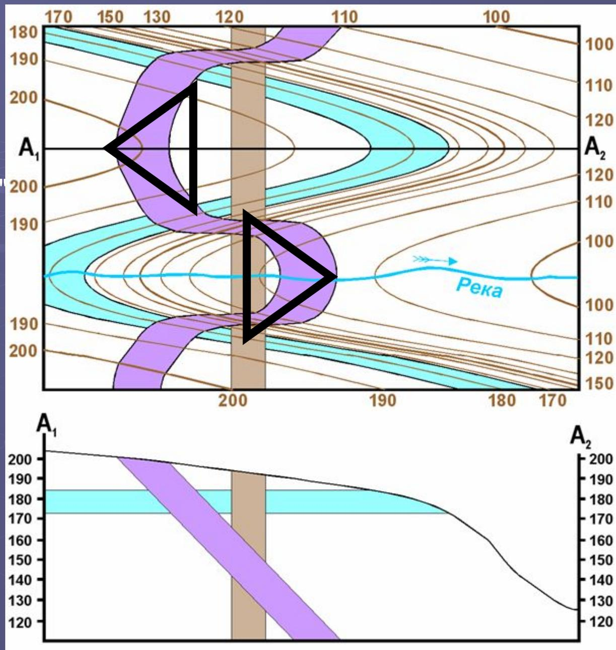
Правило пластовых треугольников: «Пластовый треугольник в долине указывает направление падения пласта, а на водоразделе – направление восстания» и в этом случае "работает"
