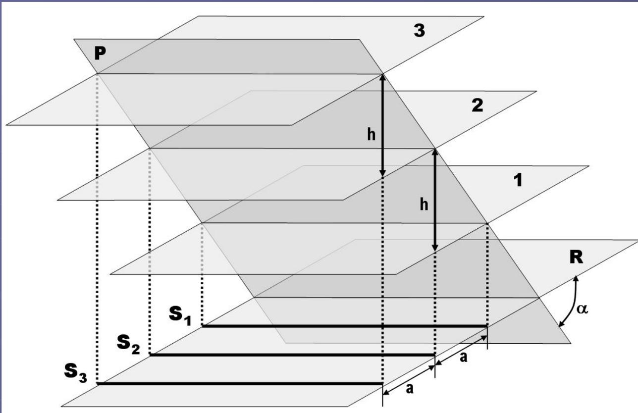
При решении задач структурной геологии часто используется универсальный инструмент – построение линий равных высот поверхности пласта, или *стратоизогипс*, которые являются аналогами горизонталей рельефа, только проводятся для поверхности пласта
