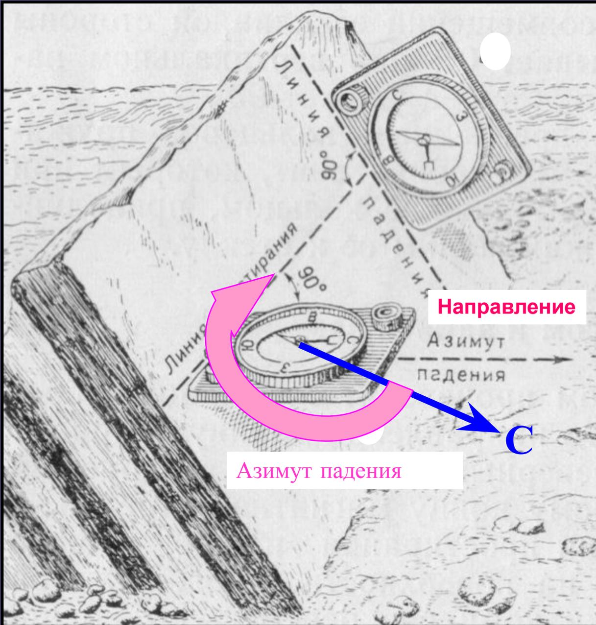
1. Чтобы измерить азимут падения слоя, надо, **держа компас горизонтально** (контроль по уровню), приложить его короткой стороной к линии простиранья, направив северным концом по направлению падения пласта и взять отсчет по северному концу стрелки.
