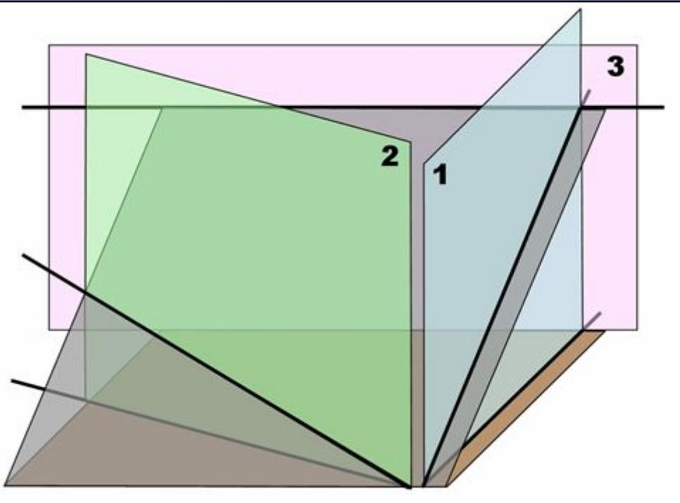
**1** вертикальная плоскость сечет наклонный пласт вкрест простирания;
