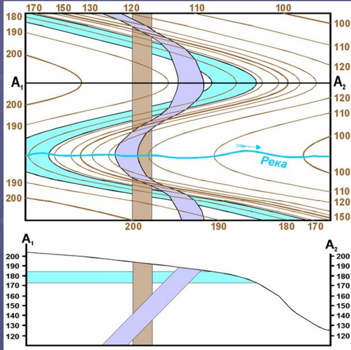
Выход пласта, наклоненного под склон, на карте занимает положение между выходами горизонтального и вертикального пластов, т.е. его выход "изогнут" в ту же сторону, что и горизонтали, но с меньшей кривизной
