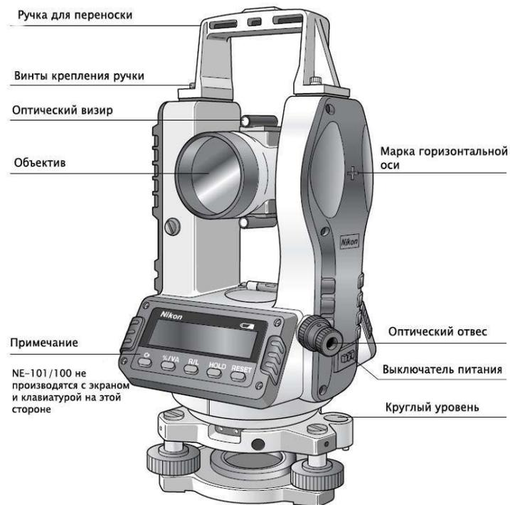
Современные теодолиты обеспечивают измерения углов горизонтальных и вертикальных не только при геодезических работах, но и в топографической съемке местности, маркшейдерских и горных работах в шахтах, туннелях и пр., работах по строительству, азимутальных определениях, других задачах, связанных с необходимостью точных измерений и выносом проектов в натуру.
