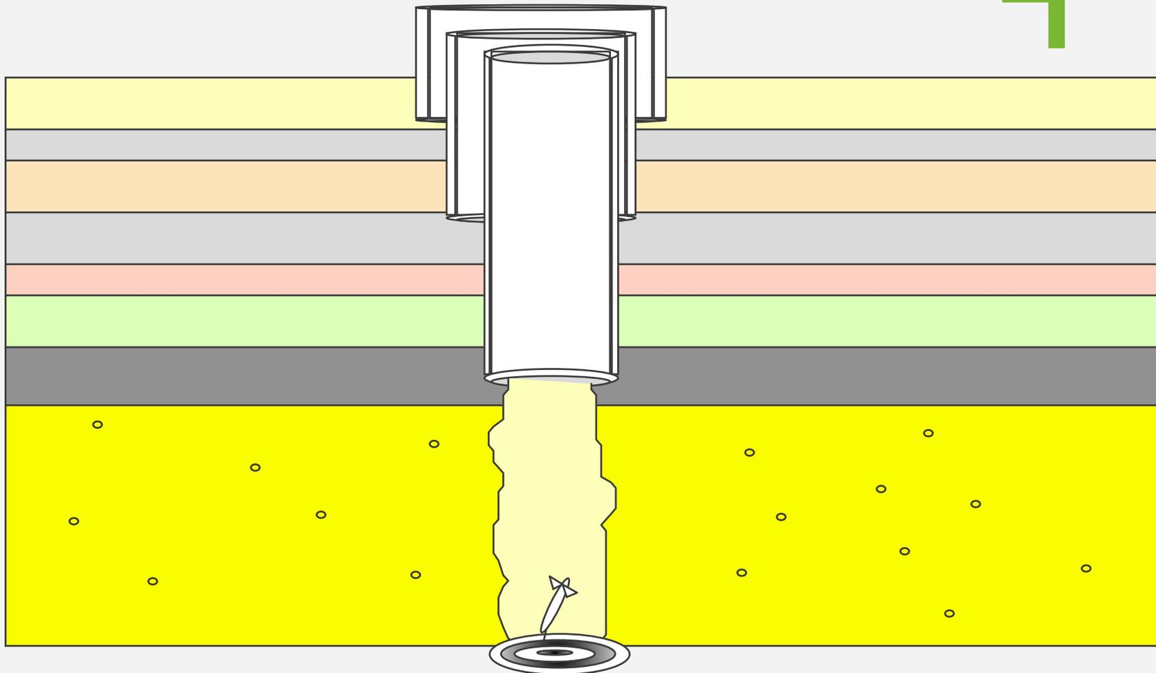
Затем, мы производим перфорации в скважине для создания специальных отверстий, по которым нефть из продуктивных слоев будет поступать в скважину
