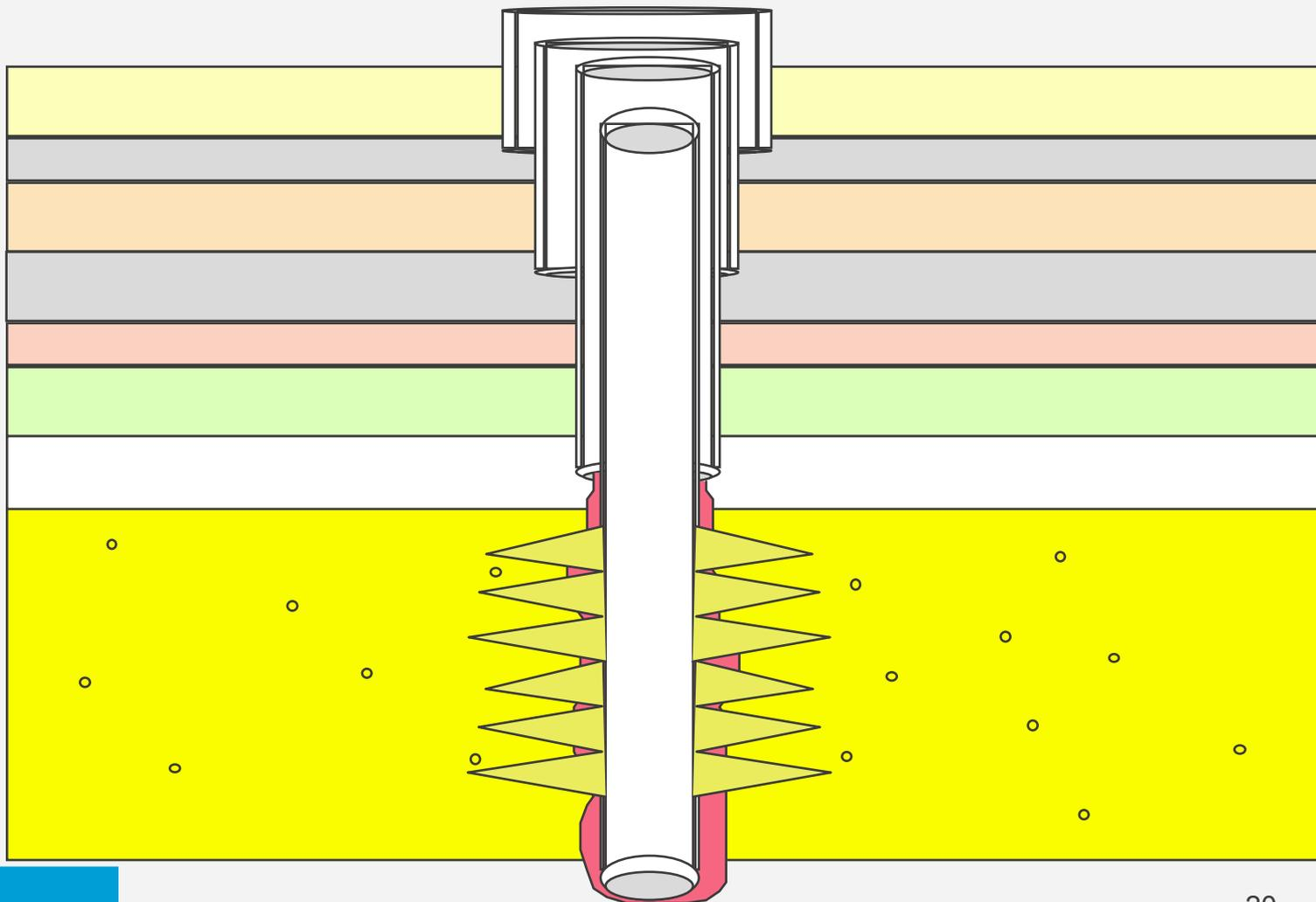
Включается насосно-компрессорная колонна, а нефтеносный интервал ограничивает манжетой для предотвращения проникновения нефти в другие зоны.
