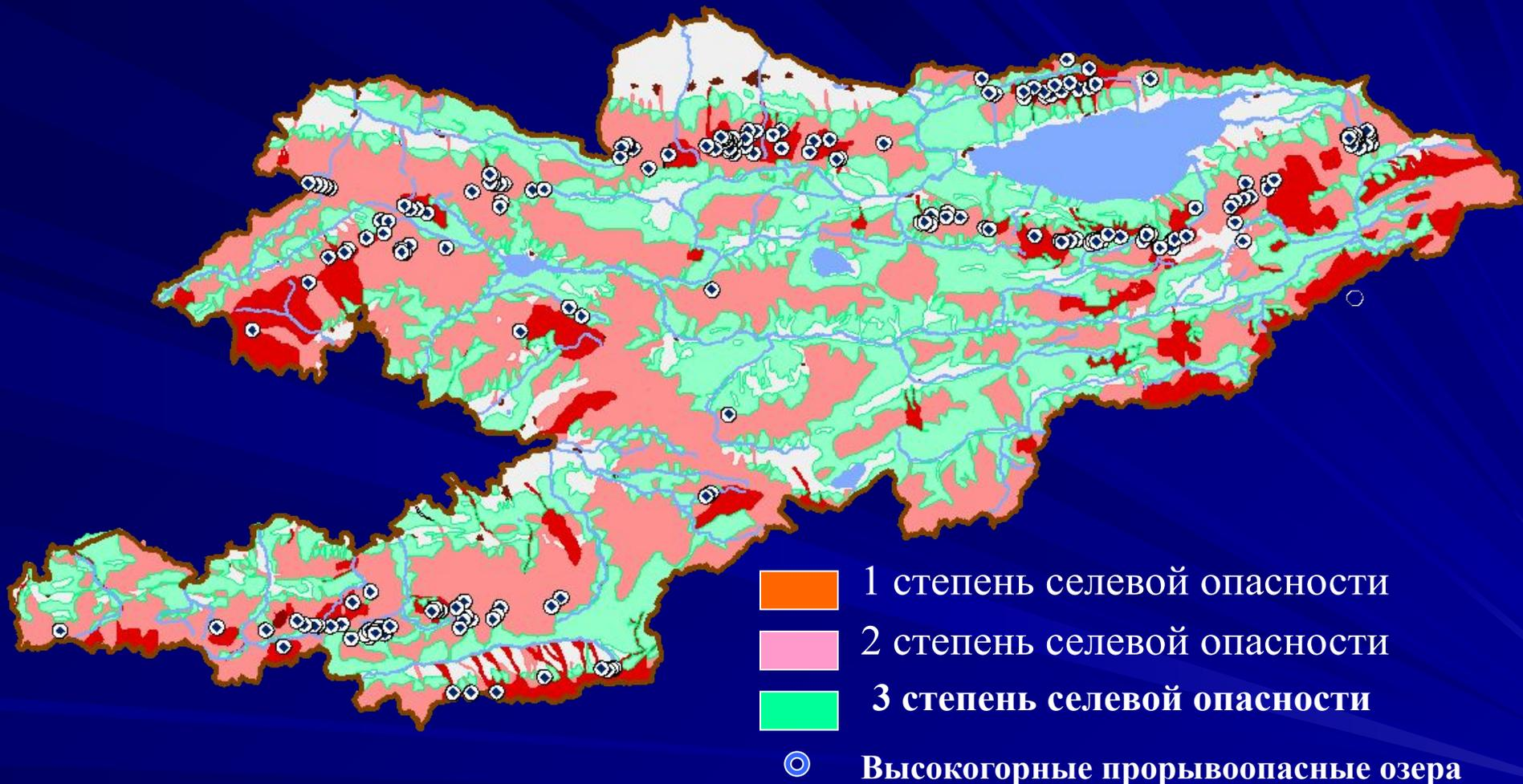
На территории Кыргызстана насчитывается около 3900 селевых бассейнов рек, а также до 2000 высокогорных прорывоопасных озер из которых до 200 имеют высокую вероятность прорыва. В зонах возможного поражения различной степени находится более 300 населенных пунктов. В 1153 населенных пунктах зафиксированы случаи селевых потоков приведших к различным ущербам
