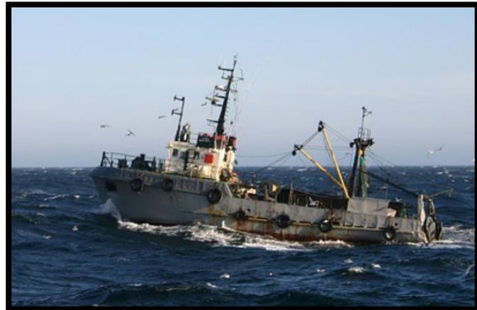
Сейнер— рыбопромысловое судно для лова рыбы. Сейнер — обычно однопалубное судно с надстройкой, смещённой к носовой части. На корме имеются рабочее пространство для хранения и обработки невода.
