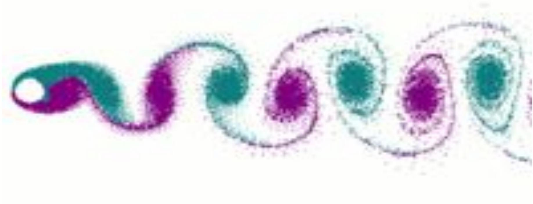
*Вихревая дорожка при обтекании цилиндра*
