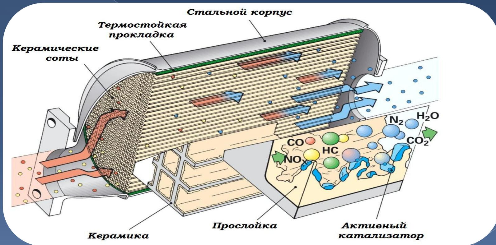
Устройство и принцип действия каталитических нейтрализаторов
