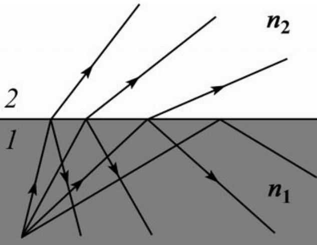
**Рис. 1.16,г.** При переходе из оптически более плотной среды 1 в оптически менее плотную 2 свет может полностью отразиться от границы раздела и не попасть в среду 2 – явление полного внутреннего отражения
