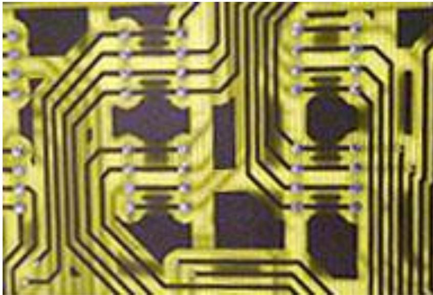
**Рис. 1.8.** Изображенные на фотопленке элементы микросхемы проецируются на кристалл кремния, где получается подобное уменьшенное (с помощью системы линз) изображение микросхемы. Специальная обработка позволяет превратить это изображение в печатную микросхему
