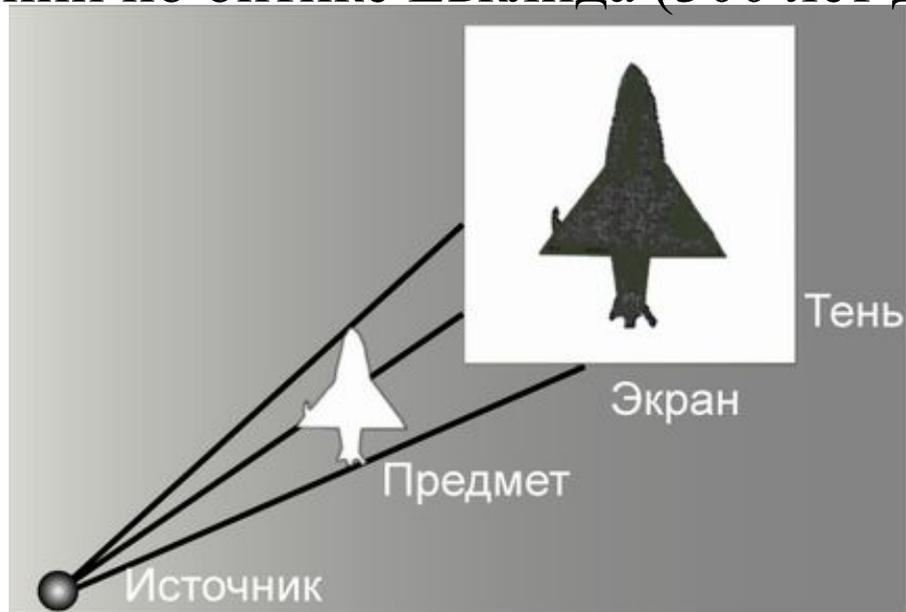
**Рис. 1.4.** Тень, отбрасываемая предметом, обусловлена прямолинейностью распространения световых лучей в оптически однородных средах
