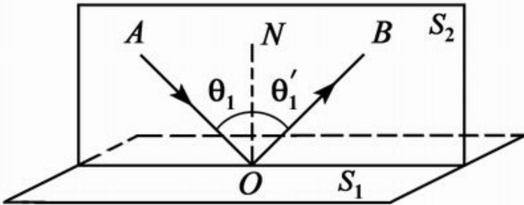
**Рис. 1.12.** Угол падения равен углу отражения.  $S_1$  - отражающая поверхность;  $S_2$  - плоскость падения;  $AO$  - падающий луч;  $OB$  - отраженный луч;  $ON$  - нормаль к отражающей поверхности.
