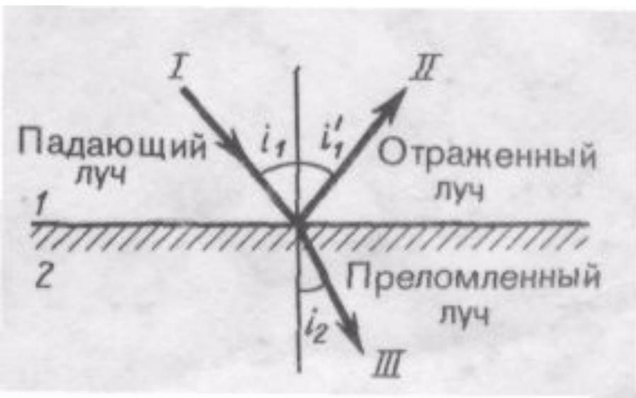
**Рис. 1.11.** Схема хода лучей при преломлении
