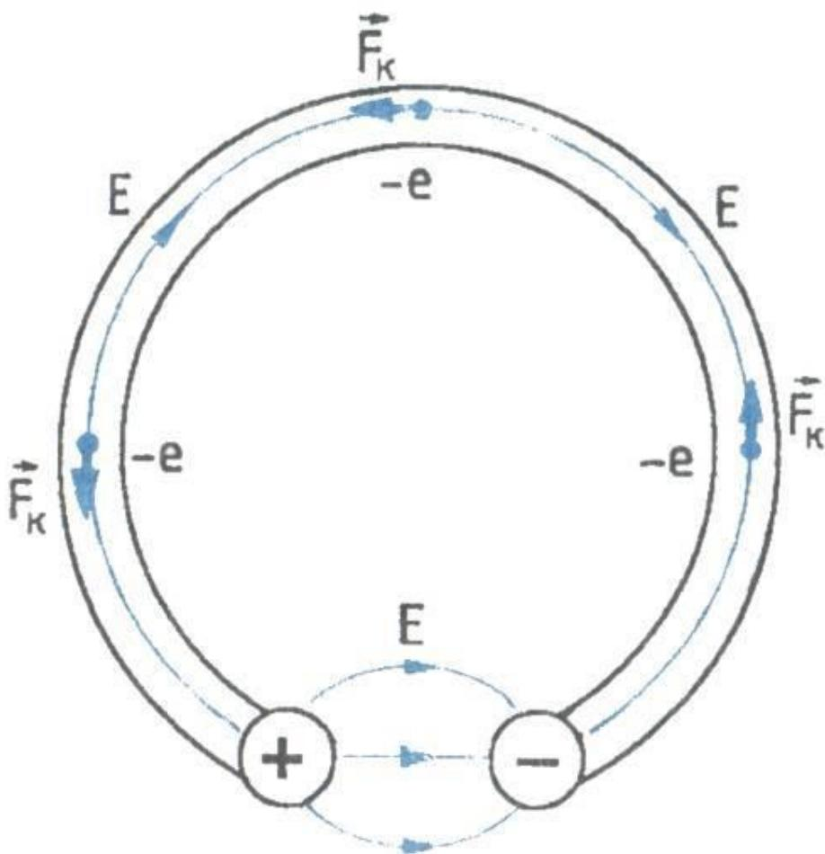
Соединим проводником два металлических шарика, несущих заряды противоположных знаков. Под влиянием электрического поля этих зарядов в проводнике возникает электрический ток.
