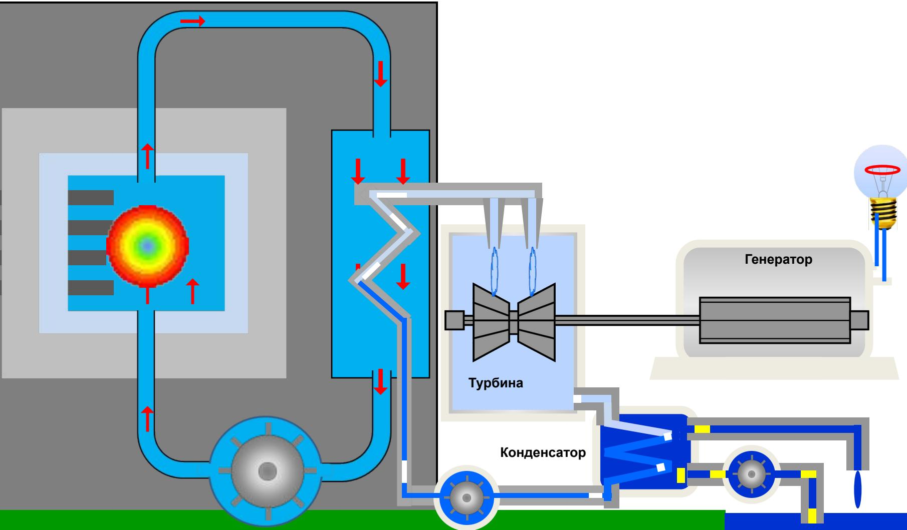
Схема работы АЭС
