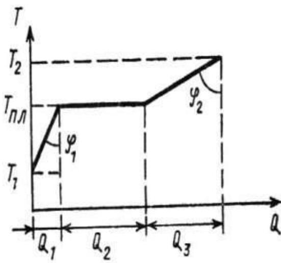
На рисунке представлен график зависимости температуры льда от полученной теплоты.  $Q_1$  – теплота, полученная льдом при нагревании;  $Q_2$  – теплота, полученная льдом при плавлении;  $Q_3$  – теплота, полученная растаявшим льдом при нагревании; тангенс углов наклона  $\varphi_1$  и  $\varphi_2$  пропорционален величинам теплоемкости льда и воды.
