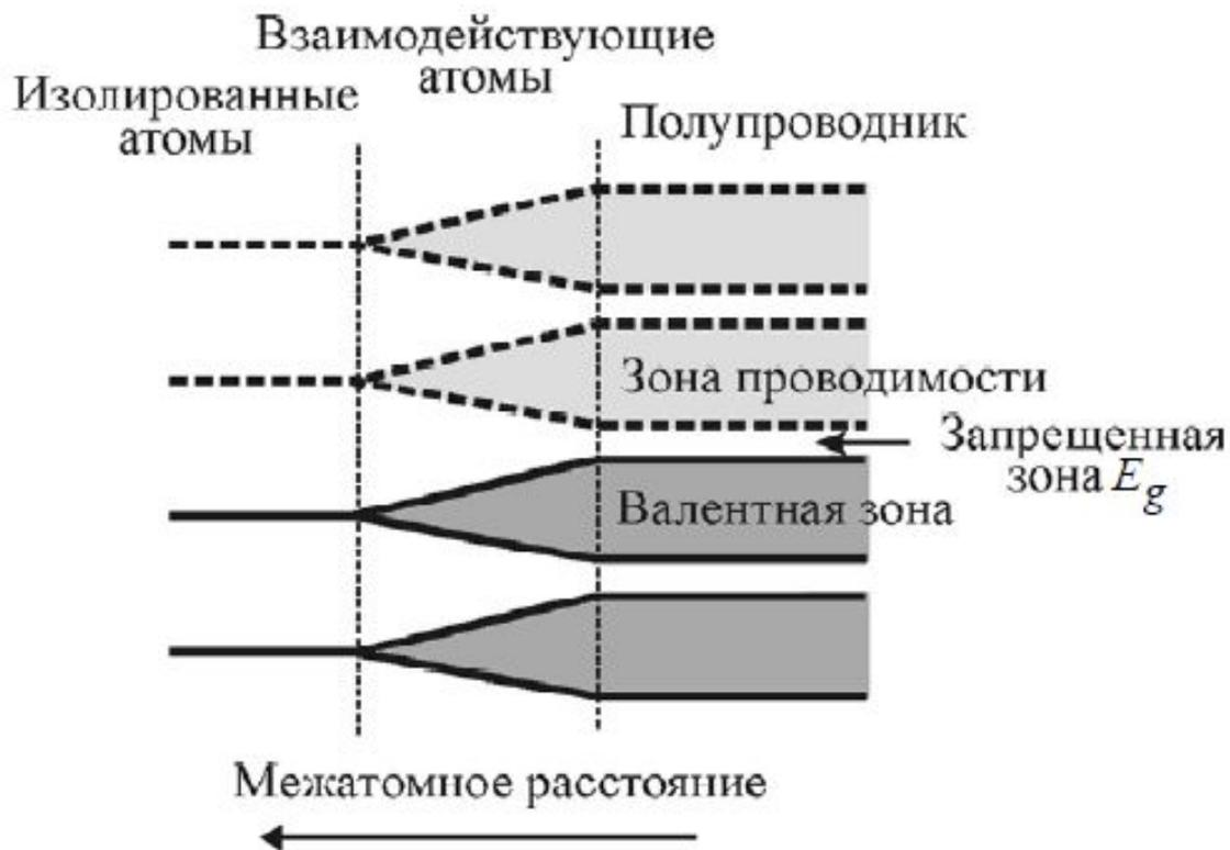
Формирование электронных зон в твердом теле из энергетических уровней изолированных атомов
