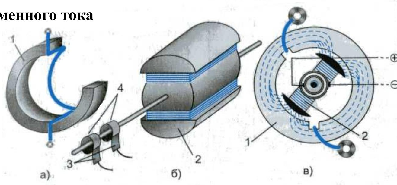
Статор (рис а) это стальная станина в которую укладываются медные провода. Ротор (рис б) это стальной сердечник с обмоткой проводов, по которому идёт постоянный ток, создаёт магнитное поле. Когда ротор вращается (рис в), к примеру под действием ветра в ветряках, магнитное поле ротора пересекает обмотки проводов статора и возникает переменный ток.
