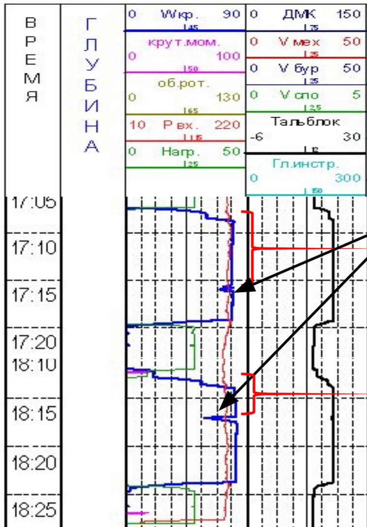
Происходит гидравлическая задержка перед ударом вверх. Вес на крюке 79 тонн.
