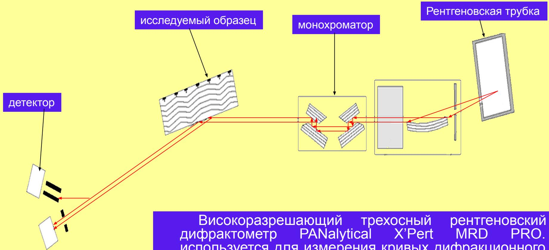
Високоразрешающий трехосный рентгеновский дифрактометр PANalytical X'Pert MRD PRO. используется для измерения кривых дифракционного отражения (КДО). На трехосном дифрактометре фирмы "Philips" находится: на первой оси - германиевый монохроматор из четырехкратным отражением, на второй - исследуемый образец, на третьей кристалл - анализатор .
