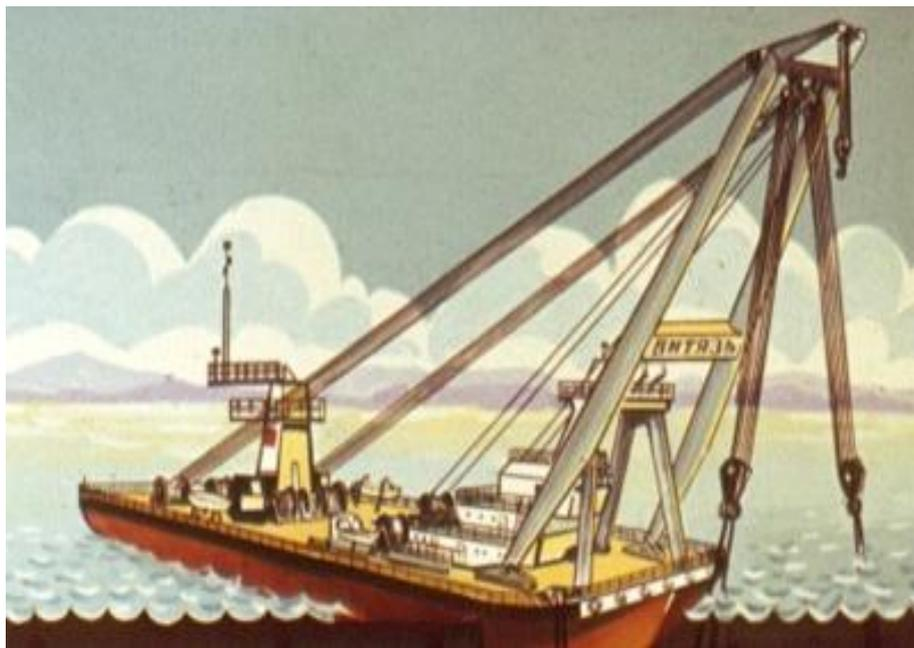
*Плавающие краны - самые сильные из семейства подъемных кранов: их грузоподъемность 4000 кН. Они поднимают затонувшие корабли, снимают суда с мели, с их помощью ремонтируют суда в открытом море, опускают на дно батисферы и камеры для ремонта кабелей и трубопроводов.*
