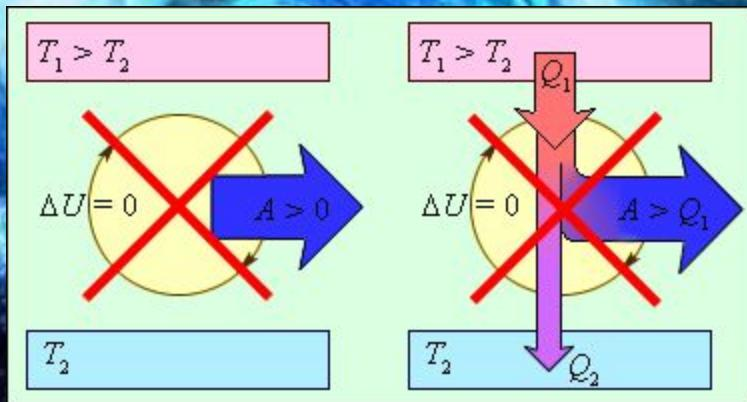
Вечные двигатели второго рода извлекают тепло из окружающей среды и превращают его в энергию механического движения. Такие устройства не могут существовать исходя из второго закона термодинамики.
