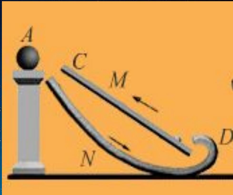
Почему двигатель не работает: Устройство работало бы, если бы магнит действовал на металлический шарик только во время его подъема на подставку по верхнему желобу. Но вниз шарик скатывается замедленно под действием двух сил: тяжести и магнитного притяжения. Поэтому к концу спуска он не приобретет скорость, необходимую для поднятия по закруглению нижнего желоба и начала нового цикла.
