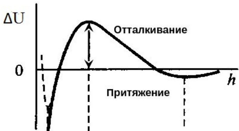
На очень малом и очень больном расстоянии  $\Delta U < 0$ , и частицы притягиваются, но если они находятся на расстоянии примерно  $10^{-5}$  м, то они будут отталкиваться.
