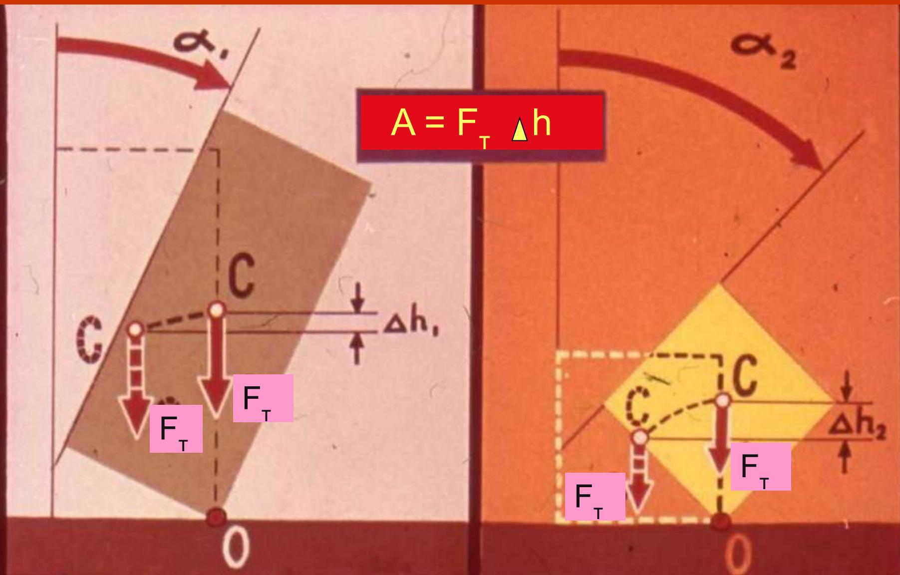
Два тела, у которых одинаковы вес и площадь опоры, но разная высота, имеют разный предельный угол наклона . Если этот угол превысить, то тела опрокидываются.
