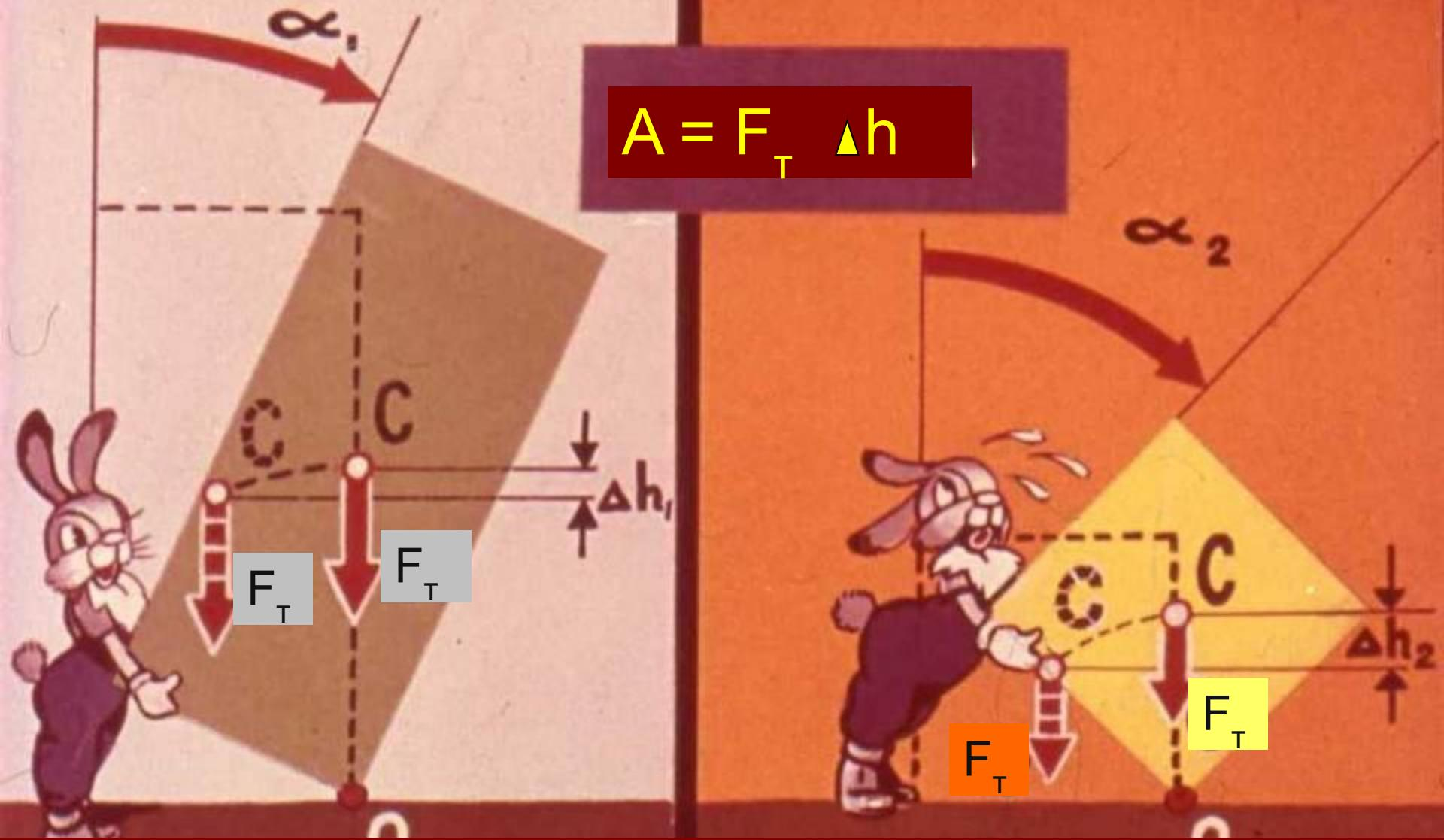
При более низком положении центра тяжести необходимо затратить большую работу для опрокидывания тела. Следовательно **работа по опрокидыванию** может служить мерой его устойчивости.
