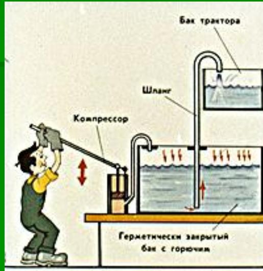
**Заправочный агрегат для снабжения тракторов горючим** действует так: компрессор нагнетает воздух в герметически закрытый бак с горючим, которое по шлангу поступает в бак трактора.
