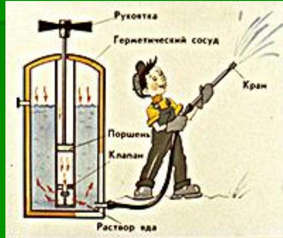
**В опрыскивательях, используемых для борьбы с сельскохозяйственными вредителями, давление нагнетаемого в сосуд воздуха на раствор яда - 500 000 Н/м<sup>2</sup>. Жидкость распыляется при открытом кране.**
