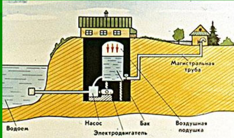
**Пневматическая система водоснабжения. Насос подает в бак воду, сжимающую воздушную подушку, и отключается при достижении давления воздуха 400 000 Н/м<sup>2</sup>. Вода по трубам поднимается в помещения. При понижении давления воздуха вновь включается насос.**
