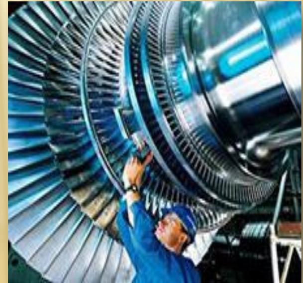
Паровые турбины работают следующим образом: пар, образующийся в паровом котле, под высоким давлением, поступает на лопатки турбины. Турбина совершает обороты и вырабатывает механическую энергию, используемую генератором. Генератор производит электричество.
