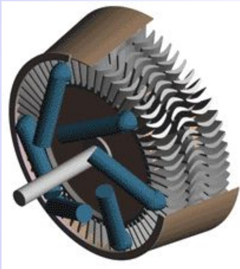
Паровая турбина – это один из типов паровых машин. Пар или нагретый до высокой температуры газ вращает вал двигателя без помощи поршня, шатуна и коленчатого вала. Паровая турбина состоит из вала, диска, лопаток. Возле лопаток расположены сопла.
