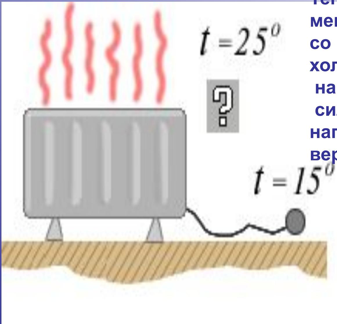
Теплый воздух имеет меньшую плотность и со стороны холодного воздуха на него действует сила Архимеда, направленная вертикально вверх.
