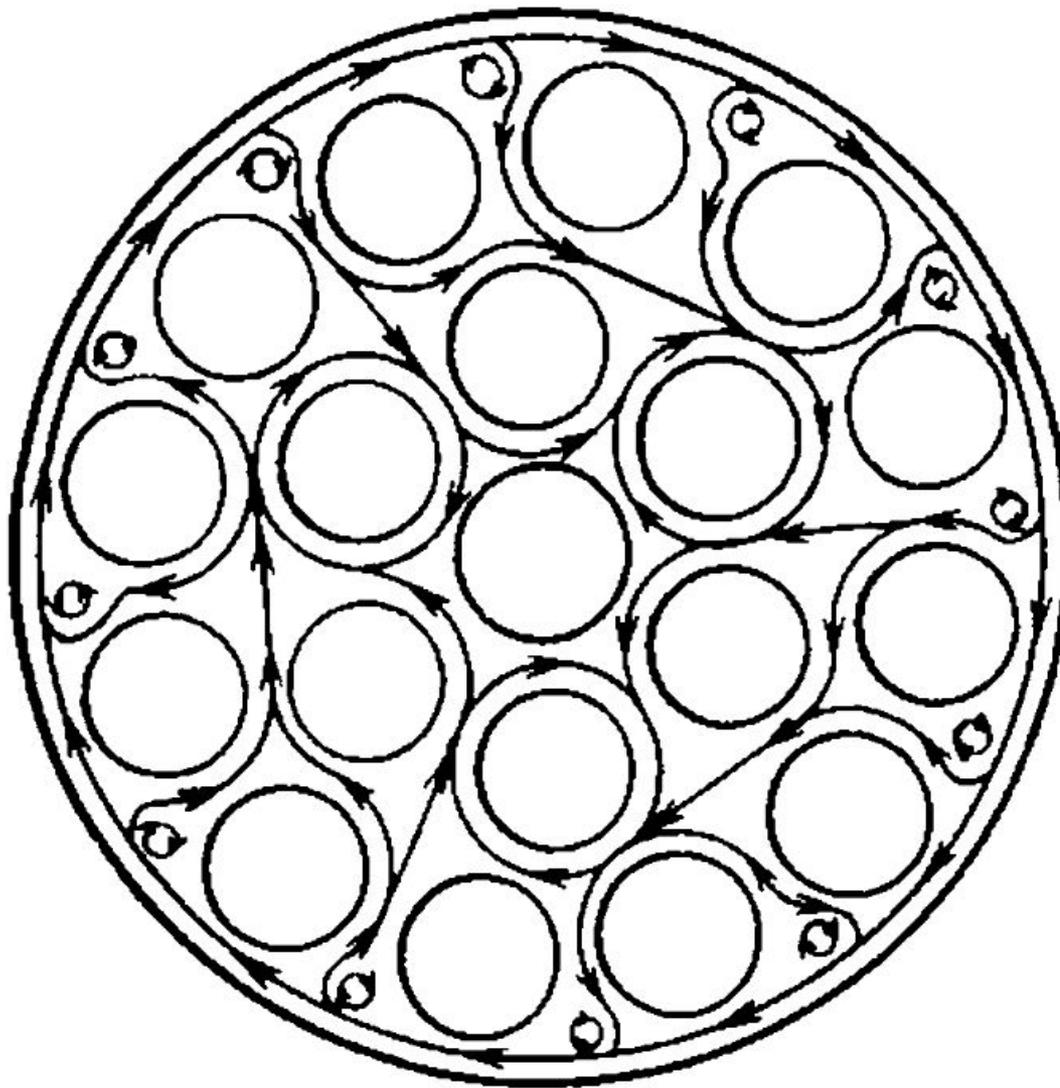
Схема циркуляция *однофазного* потока
