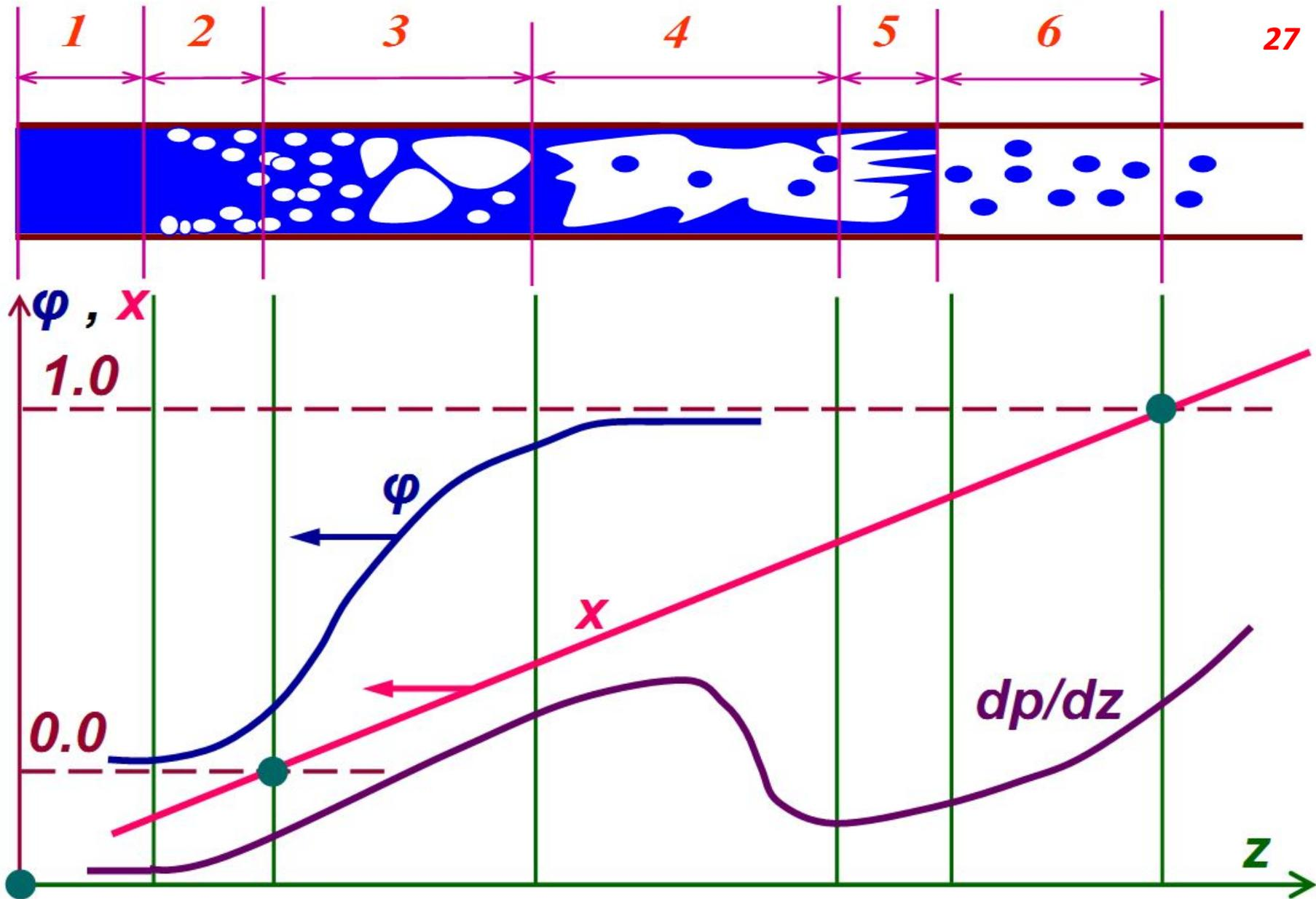
Режимы движения двухфазной смеси в канале и характер изменения по длине основных параметров двухфазного потока ( $q=const$ )
