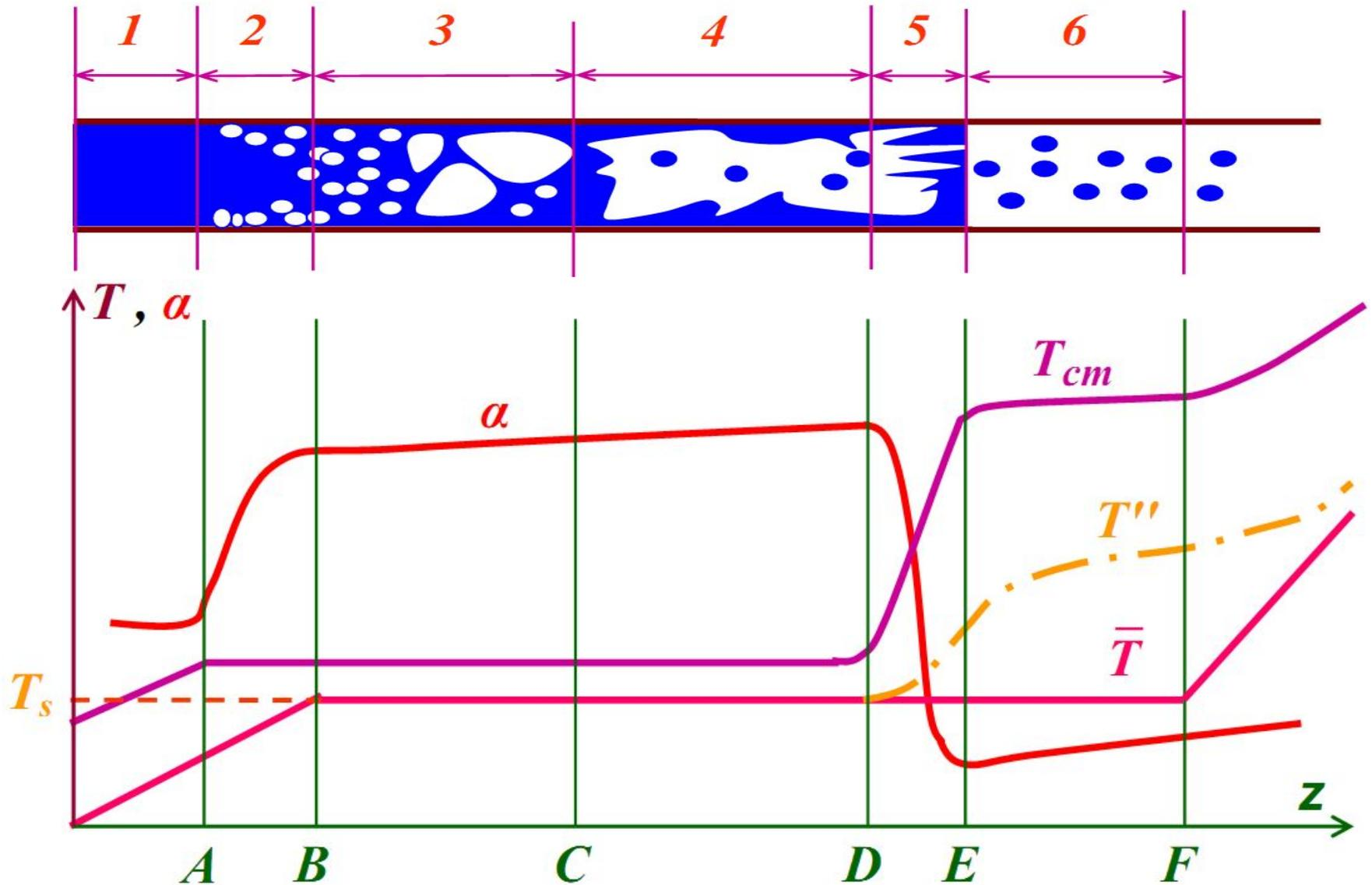
Режимы движения двухфазной смеси в канале и
