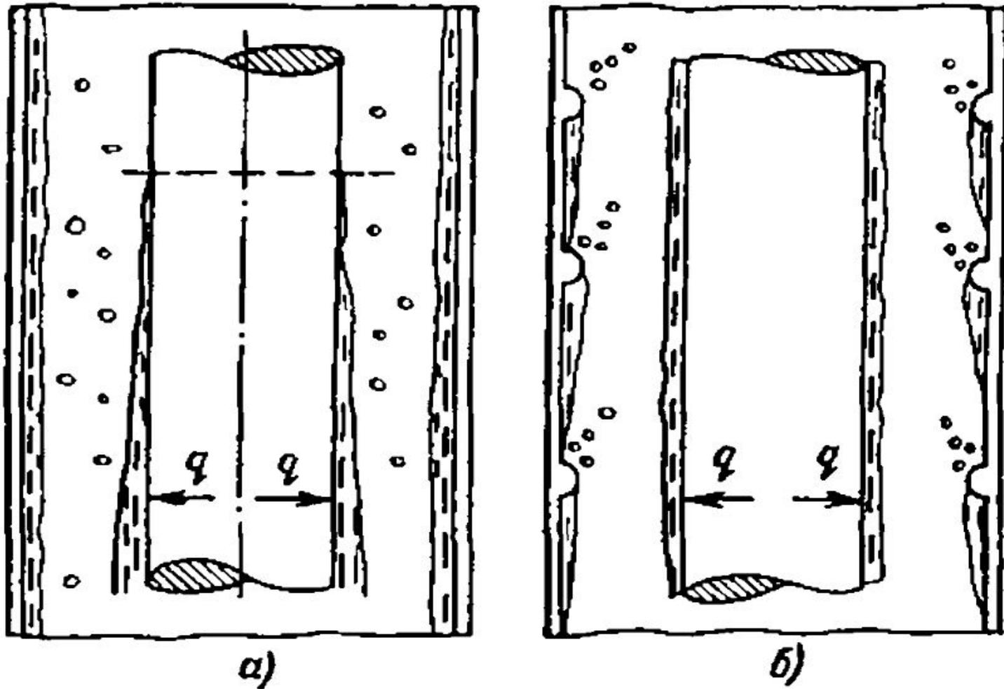
Схема действия турбулизирующих выступов
