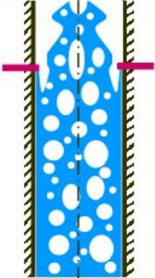
Переход развитого пузырькового кипения в плёночное; у стенок образуется плёнка пара, экранирующая жидкость «пережог» (burnout)
