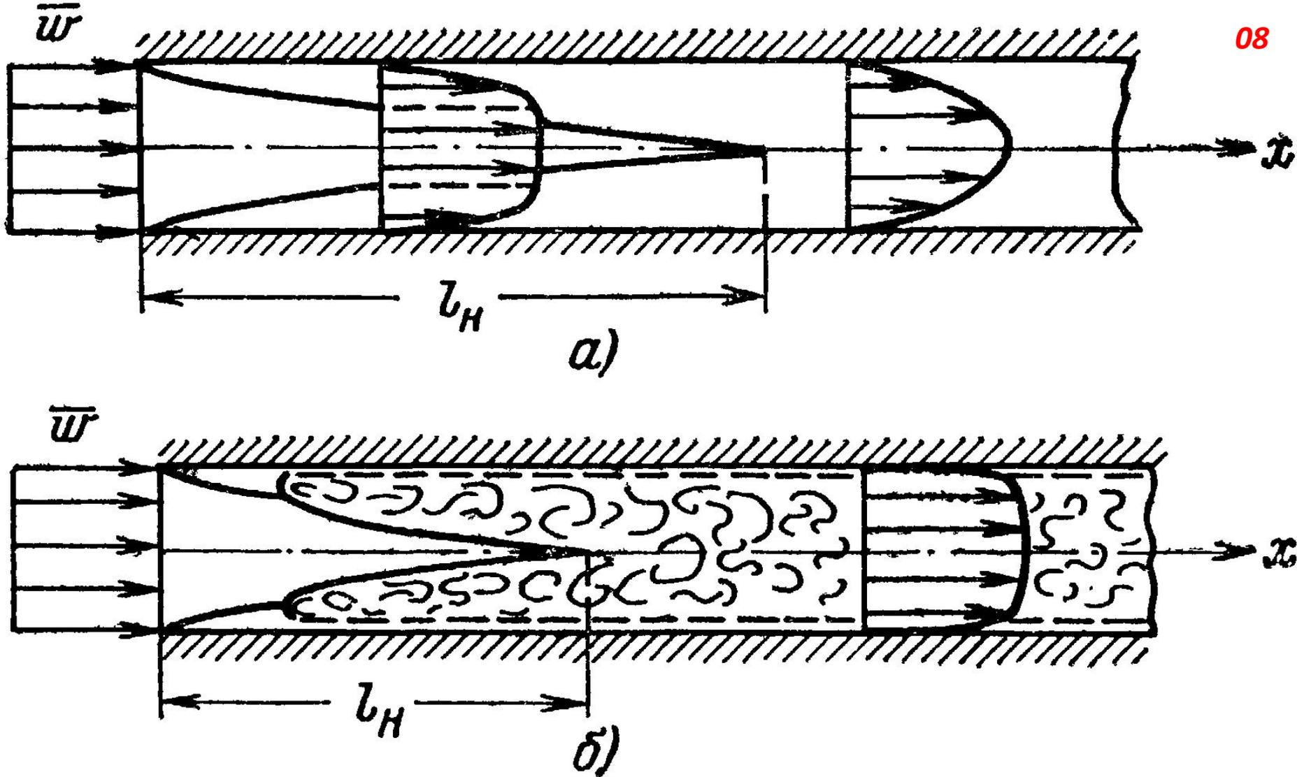
Гидродинамическая стабилизация течения жидкости в круглой трубе:
