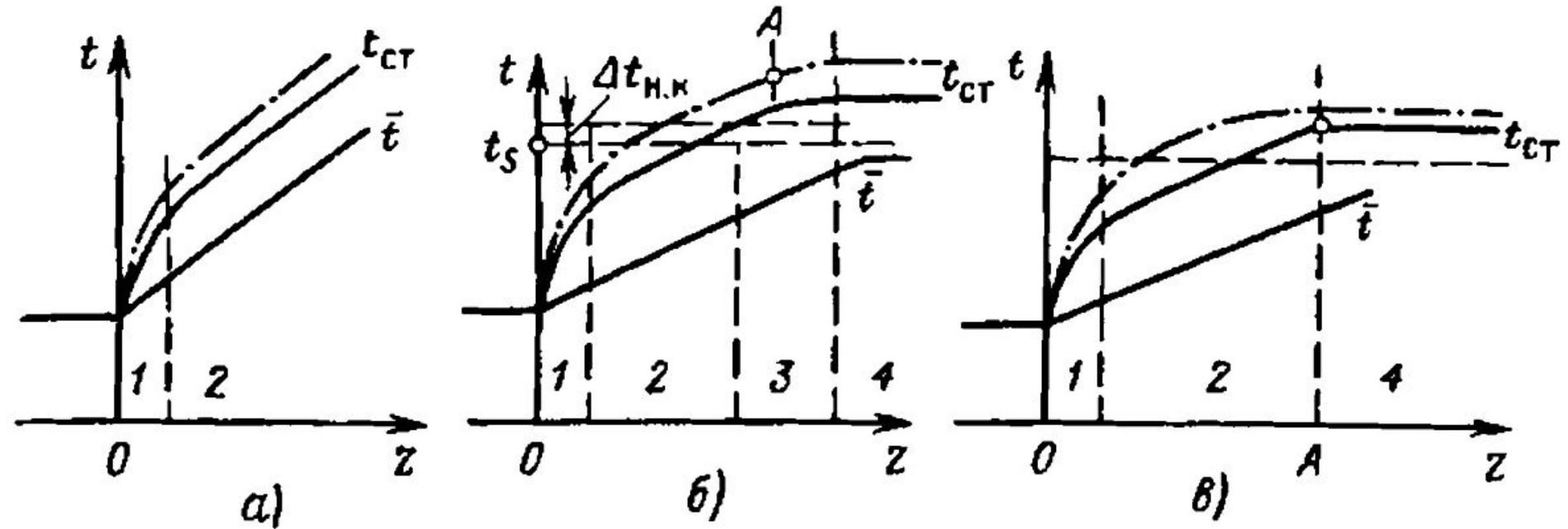
Распределение температур стенки и жидкости
