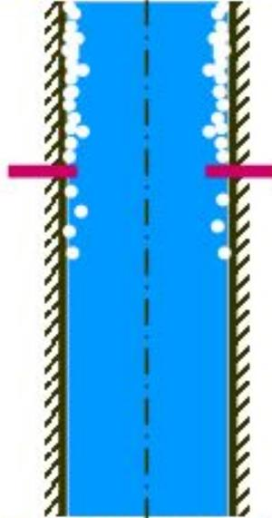
Сильно недогретая жидкость закипает у стенок, образуя тонкий слой очень мелких пузырей пара «пережог» (burnout)
