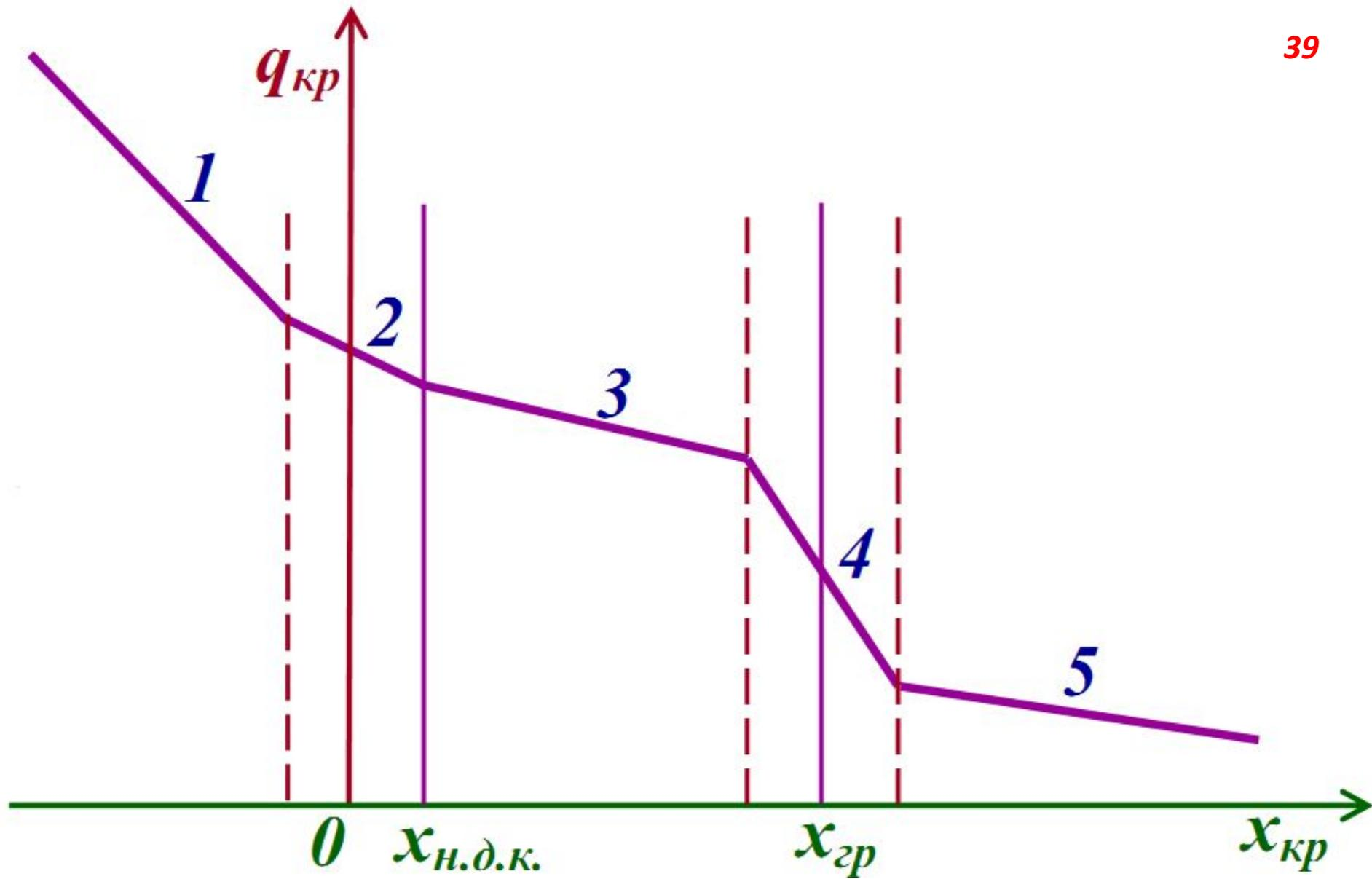
Общий вид зависимости  $q_{кр}(x_{кр})$
