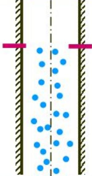
Окончание дисперсного режима: капли жидкости полностью испарились; теплоноситель однофазный – пар «высыхание» (dryout)
