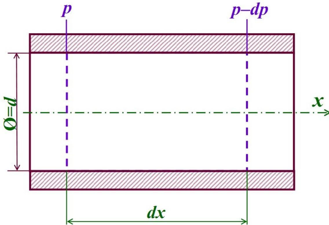
При стабилизированном течении жидкости в трубе давление уменьшается в направлении движения потока. На каждом участке перепад давлений уравнивается силой касательного напряжения трения  $\tau$  на стенках трубы, возникающего вследствие наличия сил вязкости. Для элемента жидкости, заключенного внутри объёма  $S \cdot dx = [(\pi d^2)/4] \cdot dx$  уравнение баланса сил имеет следующий вид. Сила давления, приложенная к этому объёму, равна разности полных давлений на его правой и левой гранях:
