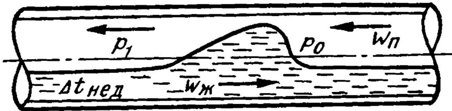
Рисунок 16 – Образование жидкостного снаряда при встречном потоке недогретой жидкости и пара
