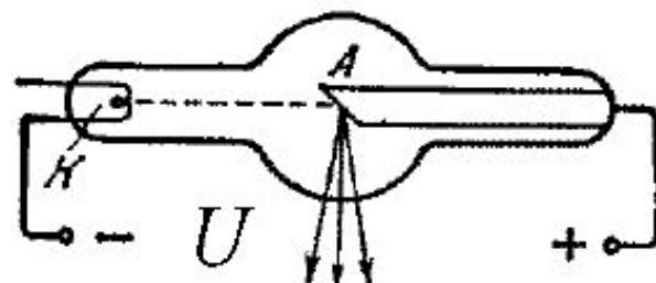
состоит из сплошного спектра **тормозного излучения**, возникающего при торможении электронов в аноде, и линейчатого спектра **характеристического излучения**, определяемого материалом анода.
