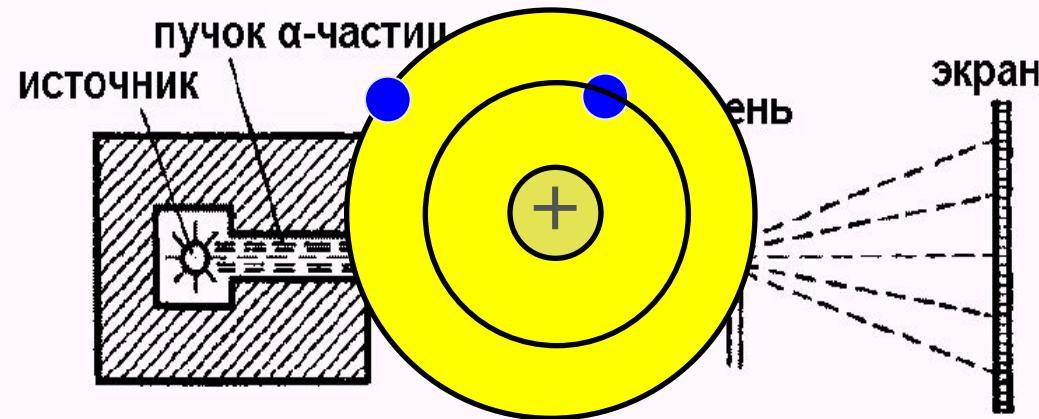
Резерфорд предложил **планетарную модель атома**. Согласно Резерфорду, атом представляет собой систему зарядов, в центре которой расположено **положительное ядро** с зарядом  $Ze$ , размером  $10^{-15}—10^{-14}$  м и массой, практически равной массе атома, а вокруг ядра, в области с линейными размерами  $\sim 10^{-10}$  м, по замкнутым орбитам движется  $Z$  электронов, образуя **электронную оболочку атома**.
