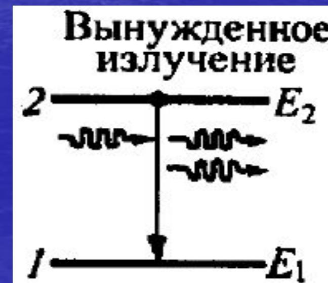
Эффект усиления излучения в активных средах используется в **оптических квантовых генераторах**, или **лазерах** (Light Amplification of Stimulated Emission of Radiation).
