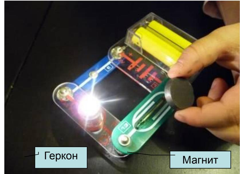
С помощью магнита и геркона я могу включить лампочку или сигнализацию, которую я сделала из моего радиоконструктора.
