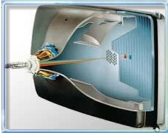
*Это свечение твёрдых тел, вызванное бомбардировкой их электронами. Благодаря катодлюминесценции светятся экраны электронно-лучевых трубок телевизоров*
