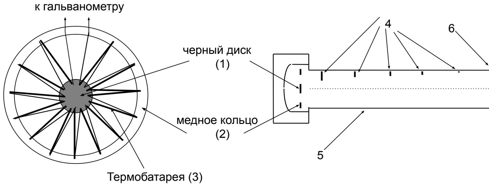
Рис. 5.1.4. Термоэлектрический актинометр М-3 (АТ-50).
